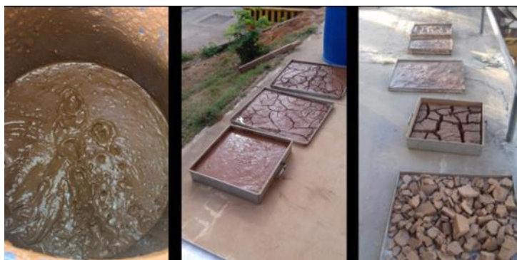
Figura 4. Processo de secagem do lodo e destorroamento.
